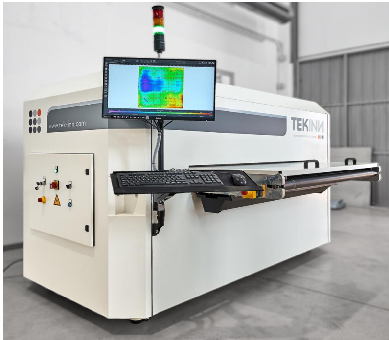
Figura 11. Tekinn. Equipo de inspección de densidad aparente y espesor de piezas cerámicas de gran formato por absorción de rayos X.
