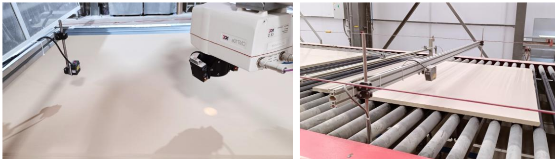
Figura 17. Sensor de humedad y sistemas de telemetría instalados sobre el lecho de polvo granulado y sobre la pieza recién prensada.
